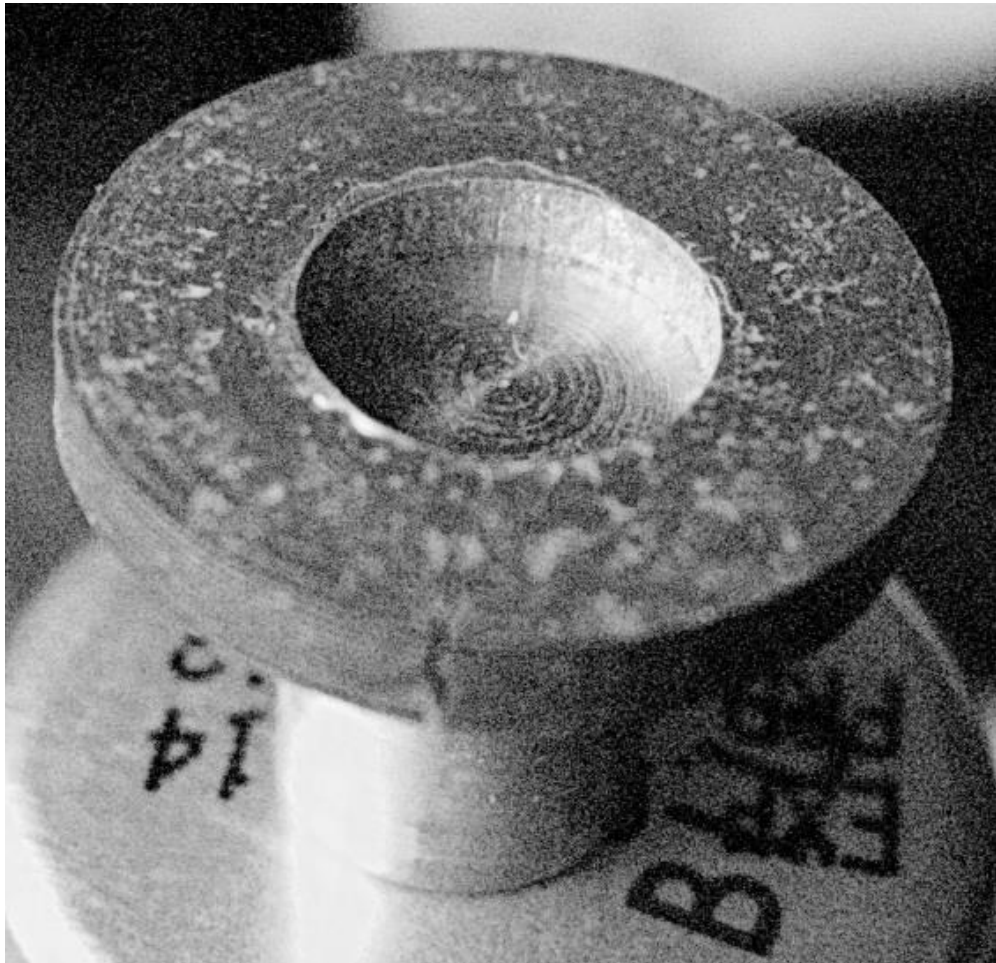
Рис. 9 Образец с ТКП Ti покрытием и напрессованной пластмассой после сдвигового испытания.
