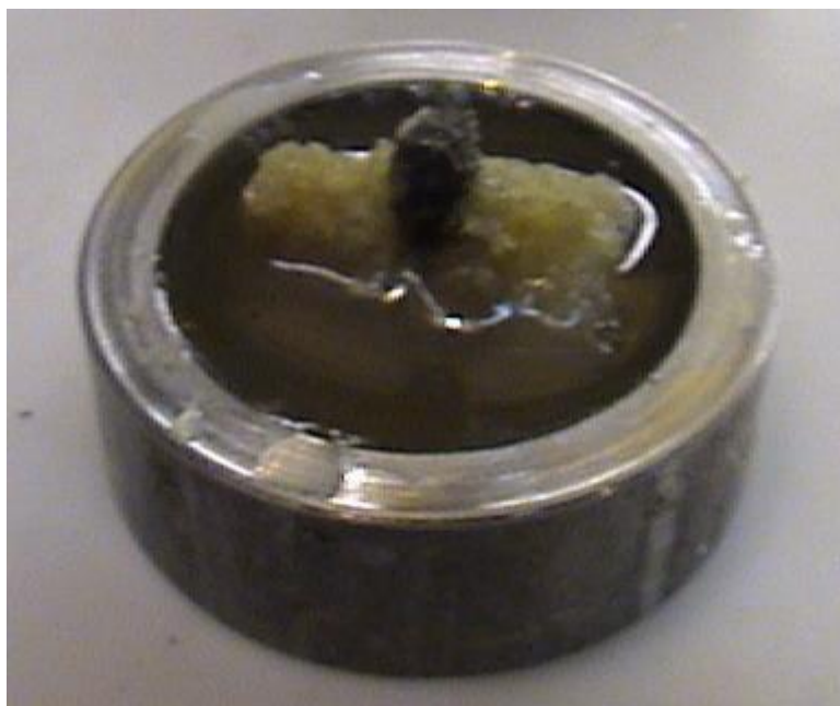
Рис. 8 Изготовление образца для сдвиговых испытаний: 1 – нижняя часть кондуктора, 2 – верхняя часть кондуктора, 3 - эпоксидная смола, 4 - имплантат, 5 - костный блок подрезался с двух торцов.
