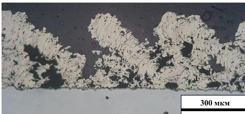
Рис. 21. Бронзовое покрытие, напыление под углом 30-45°. U=28В , I=350А , Q=80 дел, фракция порошка 71-100 мкм. Образец 1348,13.
