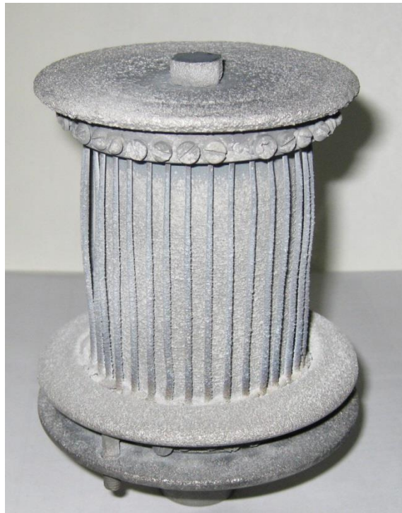
Рис. 7 Имплантаты на оснастке после плазменного ТКП Ti+ГА покрытий.
